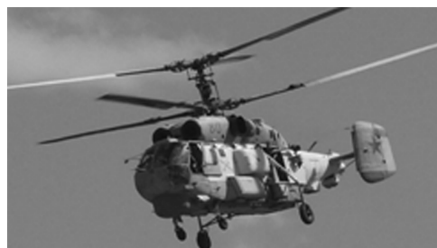
Рис. 9. Палубный поисково-спасательный вертолет Ка-27пс.
